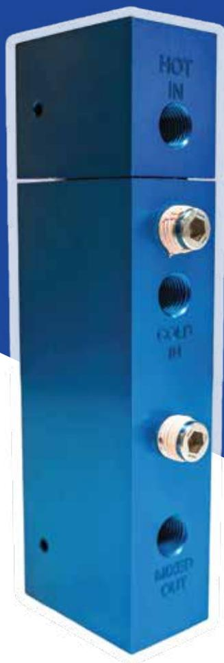
El controlador de calor constante evita el sobrecalentamiento de los instrumentos al mezclar gas natural calentado de un calentador de gas para instrumentos con gas natural a temperatura ambiente para entregar gas regulado por temperatura.
